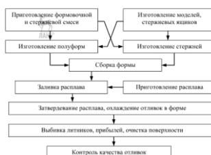
Рис. 3.3. Схема технологического процесса литья в разовые формы
