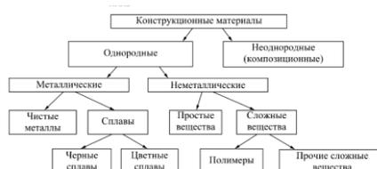
Рис. 1.1. Укрупненная классификация конструкционных материалов
