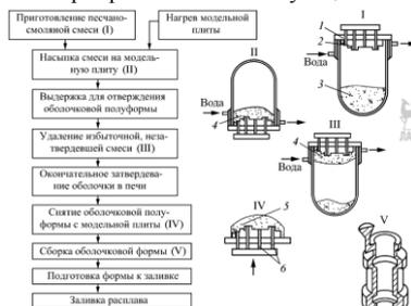
Рис. 3.6. Схема технологического процесса литья в оболочковые формы
