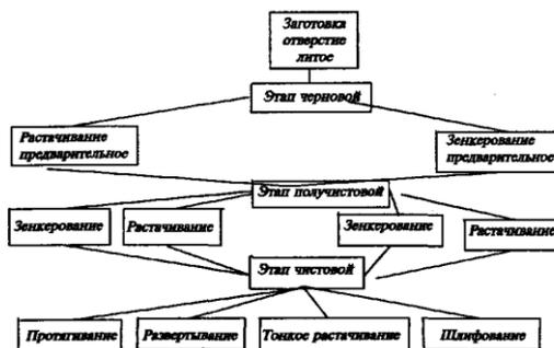
Рис. 2. Варианты обработки отверстия
