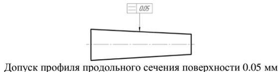
Допуск профиля продольного сечения поверхности 0.05 мм
