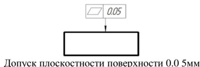
Допуск плоскостности поверхности 0.05 мм
