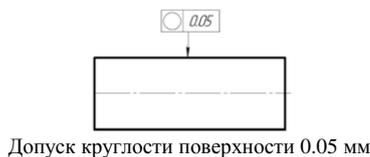
Допуск круглости поверхности 0.05 мм
