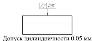
Допуск цилиндричности 0.05 мм
