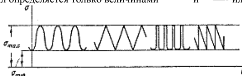
Рис.8. Виды пульсаций в циклах.
