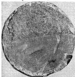
Рис.4. Характерные признаки усталостного разрушения
