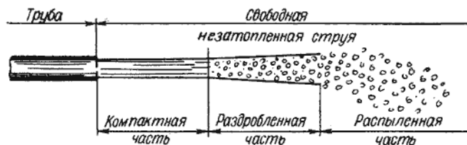
Рис. 5.16. Составные части свободной струи
