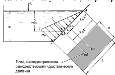
Рис. 2.3. Схема к определению равнодействующей гидростатического давления на плоскую поверхность
