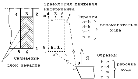
Рис. 4.2. Обточка цилиндрической наружной поверхности поперечным движением реза
