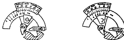
Рис. 3.12. Определение геометрических элементов с помощью прибора для контроля параметров многолезвийного инструмента
