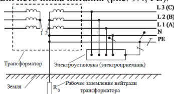
Рис. 9.4. Трехфазная сеть с подключенным к ней электроприемником
