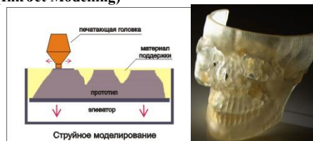
Рис. 5.7. Принцип работы IJM-машин
