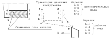
Рис. 4.1. Обточка цилиндрической наружной поверхности продольным движением реза
