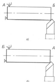
Рис. 1.7. Схема первого (а) и второго (б) установов
