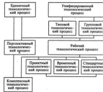
Рис. 2.1. Классификация технологических процессов
