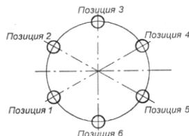
Рис. 1.8. Схема смены позиций заготовки на многошпиндельном станке
