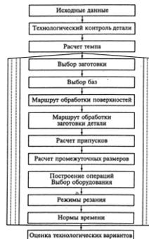
Рис. 4.2. Основные этапы проектирования технологических процессов механической обработки
