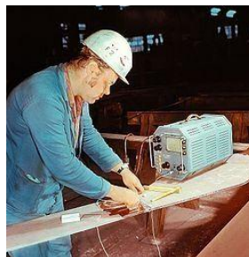
Ультразвуковой контроль изделий в ГДР, 1977 год
