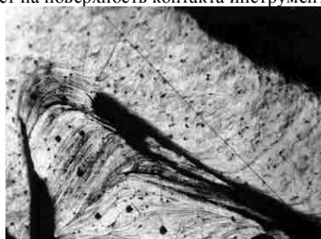
Рис.4.4. Нарост с разрушенной вершиной.
