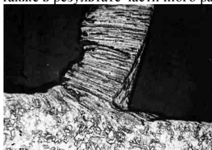
Рис.4.3. Корень стружки с наростом.
