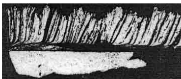
Рис.4.2. Микрофотография сливной стружки стали 12X18H10T.
