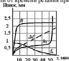
Рис.3.4 Характерные зависимости износа режущего инструмента от времени резания. Глубина резания – 1,5 мм, подача – 0,25 мм/об, скорость резания – 35 м/мин.
