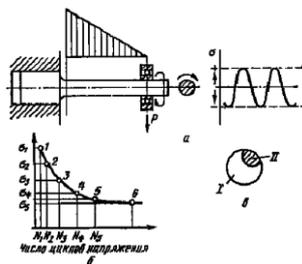
Рис. 7.5. Испытания на усталость (а), кривая усталости (б)
