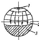
Рис 7.4. Схема зарождения и развития трещины при переменном изгибе круглого образца
