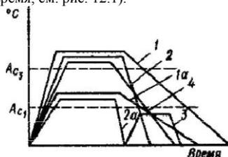
Рис.12.1. Графики различных видов термообработки: отжига (1, 1а), закалки (2, 2а), отпуска (3), нормализации (4)
