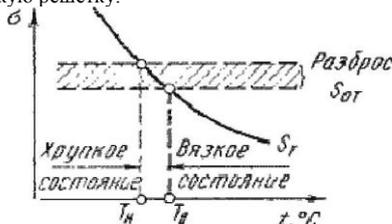
Рис. 7.2. Влияние температуры на пластическое и хрупкое состояние
