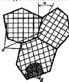
Рис. 2.6. Разориентация зерен и блоков в металле
