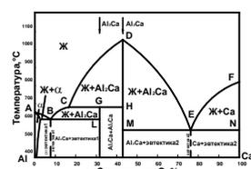
Рис 2.8 Структурная диаграмма состояния системы Al-Ca
