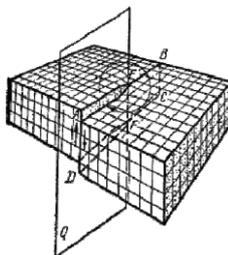
Рис. 2.4. Механизм образования винтовой дислокации
