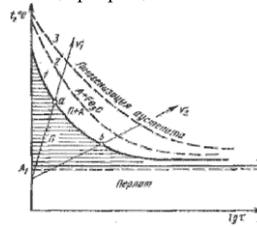
Рис. 12.3. Диаграмма изотермического образования аустенита:
