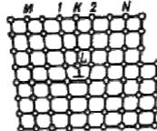
Рис. 2.3. Искажения в кристаллической решетке при наличии краевой дислокации
