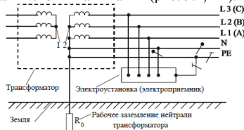
Рис. 9.4. Трехфазная сеть с подключенным к ней электроприемником
