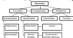
Рис. 7.1. Классификация типов вентиляции
