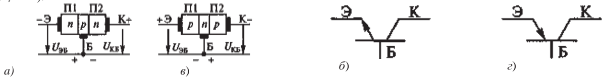
Рис. 1.12.4. Структура и графическое обозначение транзисторов: а и б – n-p-n типа; в и г – p-n-p типа
