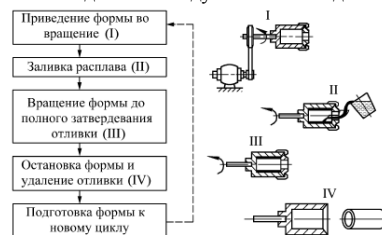
Рис. 3.9. Схема технологического процесса центробежного литья
