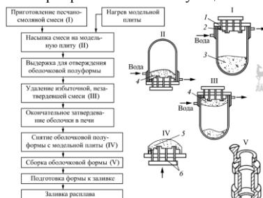
Рис. 3.6. Схема технологического процесса литья в оболочковые формы
