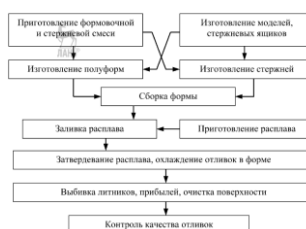
Рис. 3.3. Схема технологического процесса литья в разовые формы
