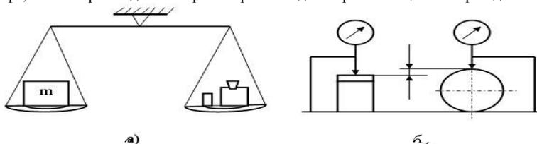
Рис. 1.5. Примеры измерений методом противопоставления и дифференцированным методом
