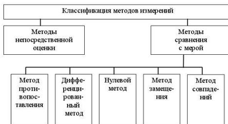
Рис. 1.4. Схема классификации методов измерений
