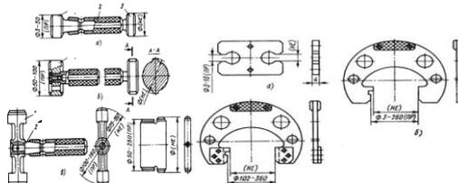
Рис. 2.2. Калибры-пробки
