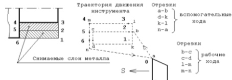
Рис. 4.1. Обточка цилиндрической наружной поверхности продольным движением реза
