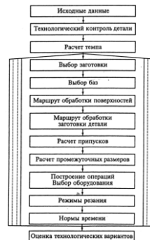
Рис. 4.2. Основные этапы проектирования технологических процессов механической обработки
