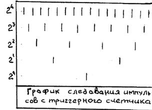
Для каждой управляемой координаты в интерполяторе имеется свой регистр памяти, своя схема объединения "ИЛИ" и свои схемы совпадения "И". Счетчик для всех координат общий. Этим обеспечивается одновременное считывание за цикл работы интерполятора всех введенных в его память чисел и в среднем равномерное распределение управляющих импульсов по каждой координате:
