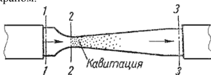
Рис. 4.2. Схема трубки для демонстрации кавитации
