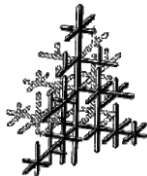
Рис.3.8 . Схема дендрита по Чернову Д.К.
