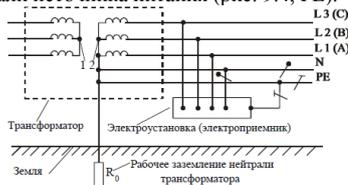
Рис. 9.4. Трехфазная сеть с подключенным к ней электроприемником
