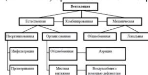
Рис. 7.1. Классификация типов вентиляции
