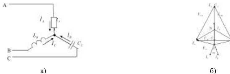
Рис. 5.1. Схема трехфазной электрической (а) цепи и векторная диаграмма напряжений и токов (б)
