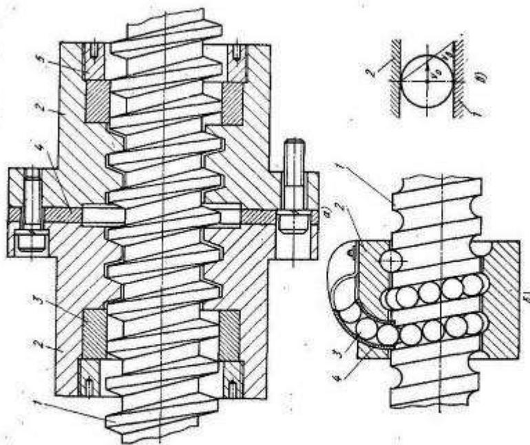
Рис. 14.8. Передача винт—гайка:
