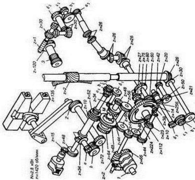
Рис. 180. Кинематическая схема зубострогального станка 5А250  $X(a/b) \times (30/72) = \text{Лдв } x/\text{мин}$ , откуда  $(a/b) = (n^{\wedge}US)$ . Из паспорта станка известно, что  $a+B = 106$ . В цепи главного движения имеются следующие сменные колеса: 30, 35, 41, 47, 53, 59, 65, 71, 76.
