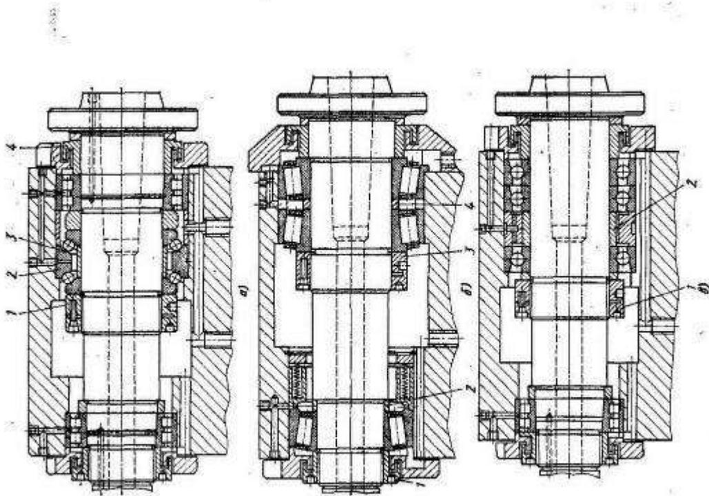
Рис. 5.4. Шпиндельные узлы токарных станков
