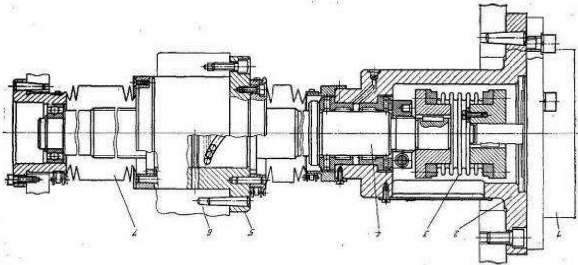
Рис. 14.11. Привод подач станка с числовым управлением: 1 — анкерный; 2 — провольный; 3 — соединительная муфта (синффон); 4 — шариковый винт; 5 — шариковая гайка; 6 — суппорт; 7 — защитная гофра
