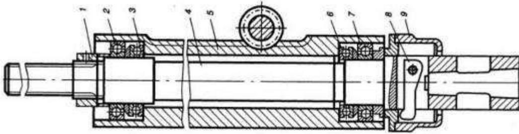
Рис. 110. Шпиндельный узел вертикально-сверлильного станка
