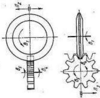
Рис. 3.6. Схема расположения и относительных движений обрабатываемого зубчатого колеса и шлифовального круга в процессе формообразования
