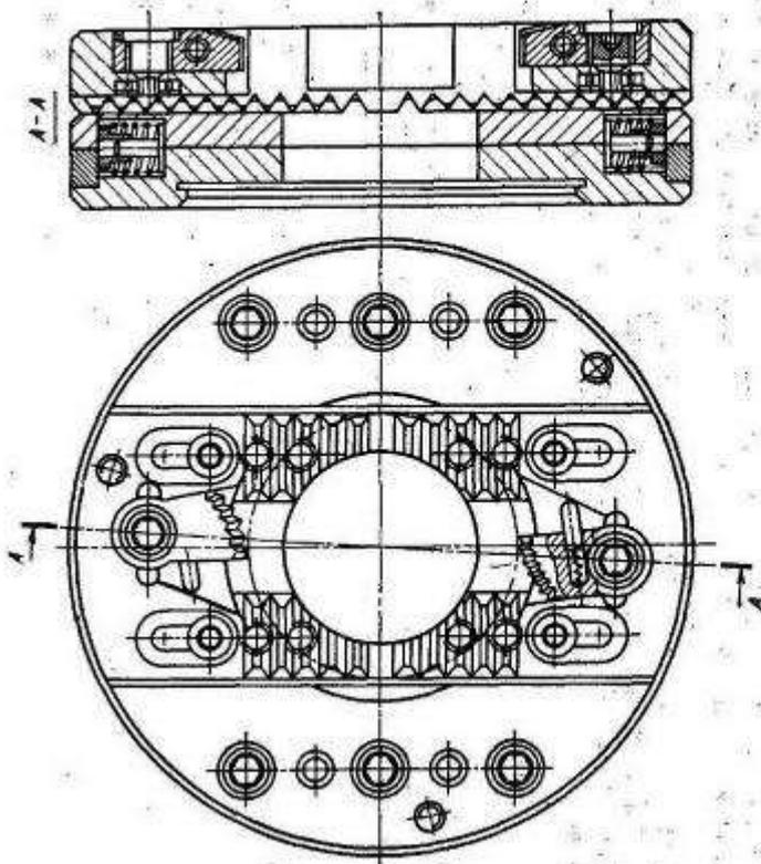
Рис. 5.12. Самоцентрирующий поворотный патрон
