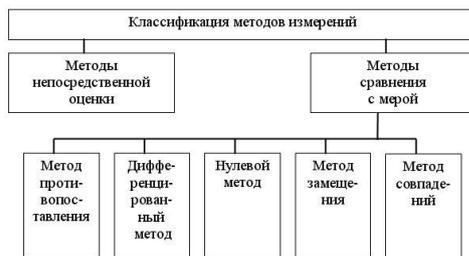
Рис. 1.4. Схема классификации методов измерений
