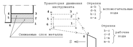
Рис. 4.1. Обточка цилиндрической наружной поверхности продольным движением реза
