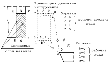
Рис. 4.2. Обточка цилиндрической наружной поверхности поперечным движением реза
