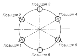
Рис. 1.8. Схема смены позиций заготовки на многошпиндельном станке
