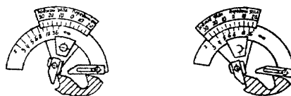
Рис. 3.12. Определение геометрических элементов с помощью прибора для контроля параметров многолезвийного инструмента
