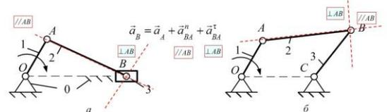
Линия действия вектора нормального (центростремительного) ускорения параллельна оси шатуна 2 и направлен этот вектор на схеме механизма от точки B к точке A (a, б).
