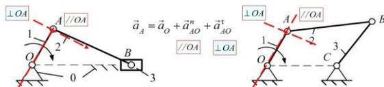
Линия действия вектора нормального (центростремительного) ускорения параллельна оси кривошипа 1 и направлен этот вектор на схеме механизма от точки A к точке O (a, б).
