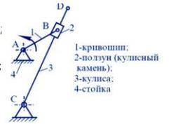
Служит для преобразования одного вида вращательного движения в другое или непрерывного вращательного движения в возвратно-поступательное движение.
