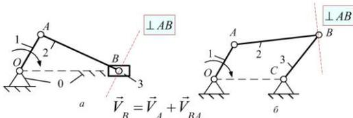
Вектор скорости точки B, принадлежащей шатунам 2 (a, б), представляет собой геометрическую сумму вектора скорости точки A и вектора скорости относительно вращательного движения точки B вокруг условно неподвижной точки A, принадлежащей этому же шатуну 2.
