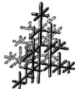
Рис.3.8 . Схема дендрита по Чернову Д.К.
