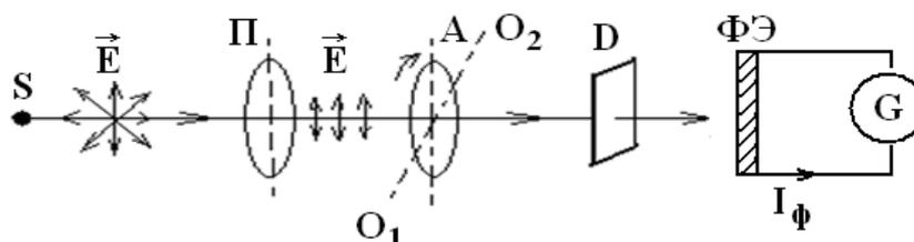
$S$  – источник света;  $P$  – поляризатор;  $A$  – анализатор;
