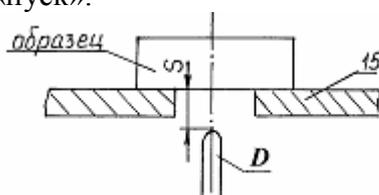
. Расположение дискового электрода относительно столика: 15 – столик для образца;  $D$  – дисковый электрод;
