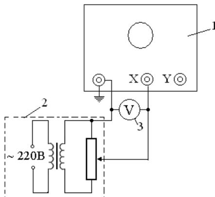
1 – осциллограф, 2 – источник регулируемого напряжения,
