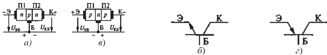
Рис. 3.2.4. Структура и графическое обозначение транзисторов: а и б – n-p-n типа; в и г – p-n-p типа
