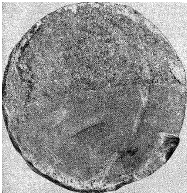
Рис.4. Характерные признаки усталостного разрушения
