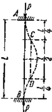
Рис.3. Расчетная схема с жесткозакрепленными торцами.
