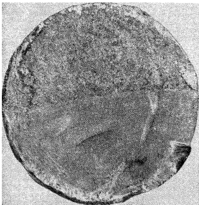
Рис.4. Характерные признаки усталостного разрушения
