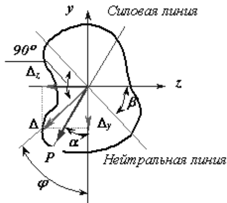
Рис.7.13. Перемещение при косом изгибе
