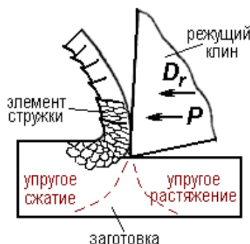
Рис. 5.1. Процесс образования стружки
