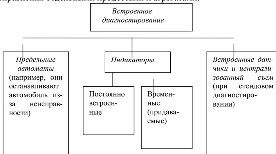
Средствами встроенной диагностики контролируются: скорость, ускорение и замедление автомобиля; частота вращения коленчатого вала двигателя; разрежение во впускном коллекторе двигателя; первичное и вторичное напряжение в системе зажигания; давление в тормозной системе; шумы; расстояние до препятствия и т.д.
