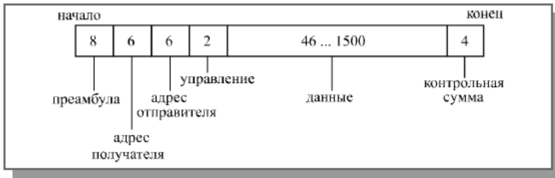
Рис. 6.1. Структура пакета сети Ethernet
