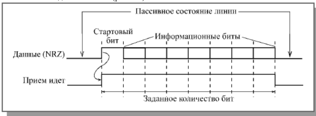
Рис. 4.3. Определение окончания последовательности при коде NRZ
