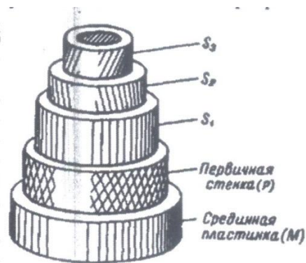
Рис.1 Схема строения клеточной стенки трахеид и либриформа.
