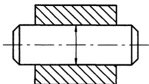
Рис. 8. Обозначение посадок на сборочном чертеже деталей:
