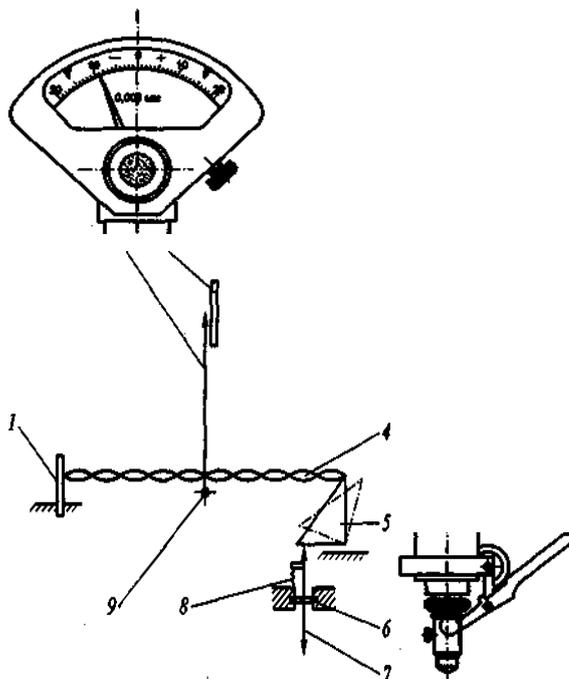
Рис. 10. Пружинная измерительная головка
