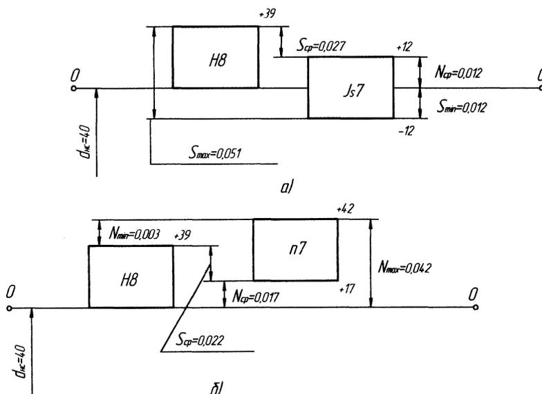
Рис. 6. Схемы полей допусков крайних переходных посадок:
