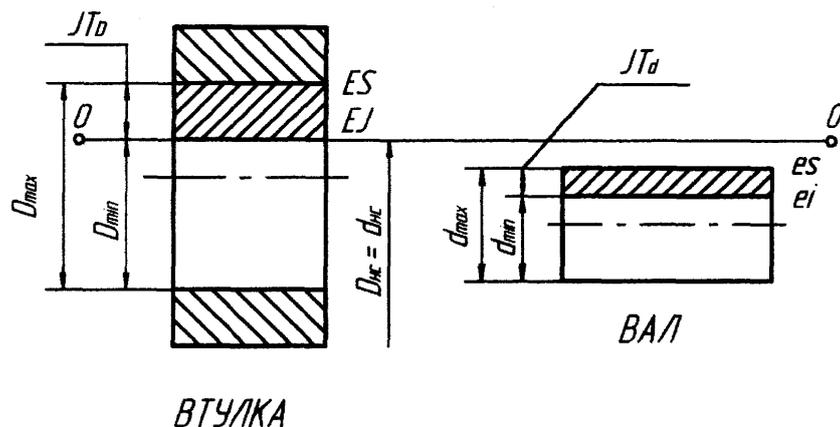
Рис. 1. Эскизы втулки и вала в соединении с зазором
