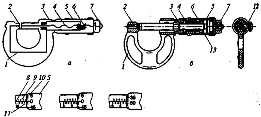
Рис. 5. Гладкий микрометр
