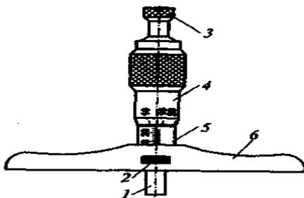
Рис. 6. Микрометрический глубиномер
