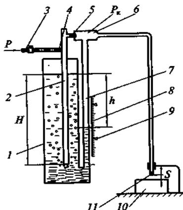
Рис.16. Пневматический прибор давления
