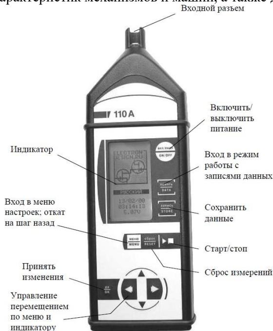
Рис. 2. Внешний вид и описание клавиш шумомера ОКТАВА-110А
