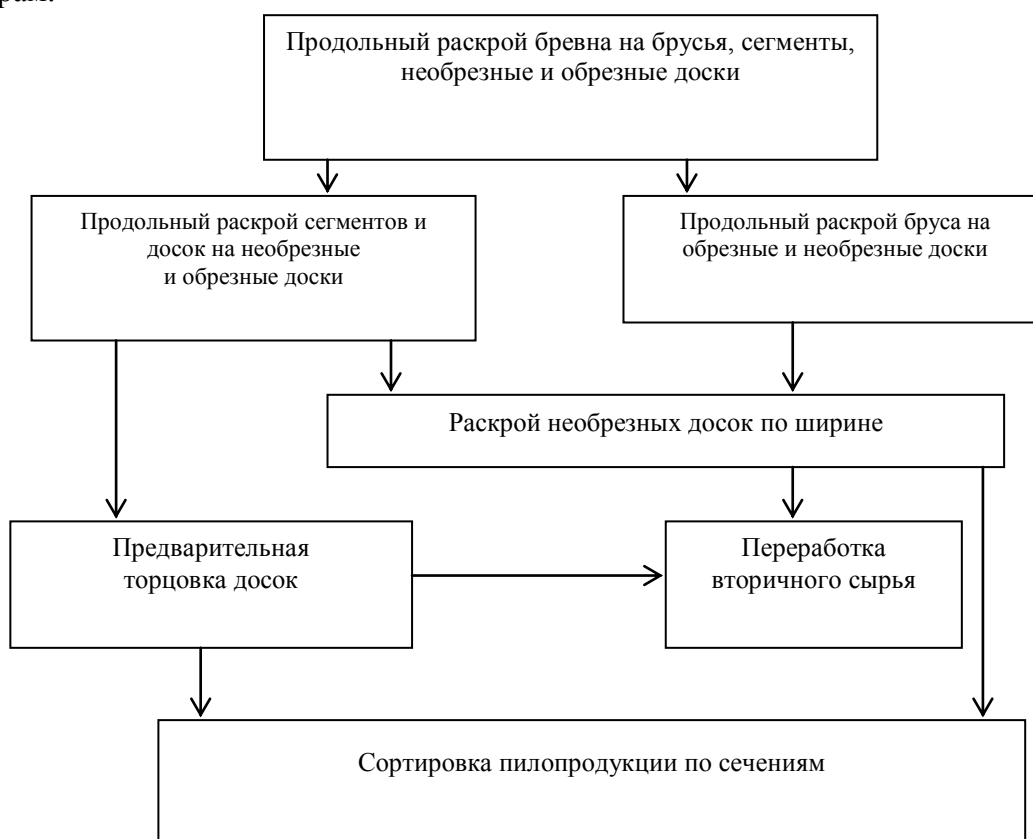
Рис.1. Принципиальная схема переработки пиловочного сырья.
