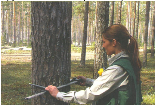
Рис. 3 Определение диаметра растущего дерева с помощью мерной вилки
