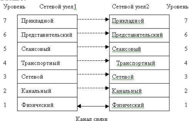
Рис. 6.18. Взаимодействие узлов сети на базе эталонной модели
