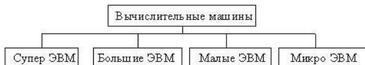
Рис. 5.4. Классификация ЭВМ по размерам и вычислительной мощности
