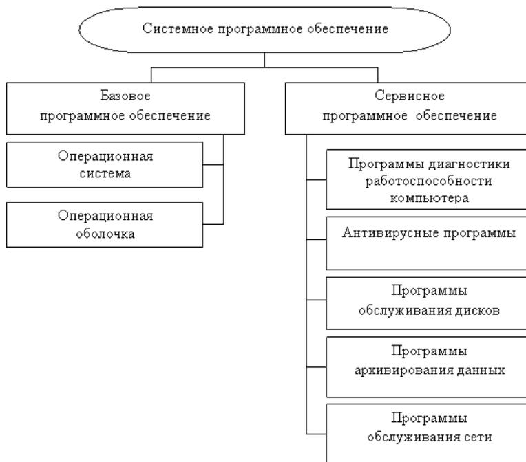
Рис. 5.2. Классификация системного программного обеспечения компьютера
