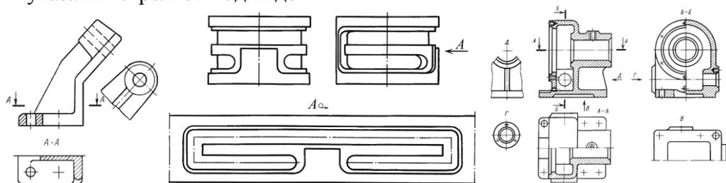
Для изображения поверхностей некоторых предметов сложной формы применяют развёрнутый вид, обозначаемый знаком  $\mathcal{Q}$ . Если изображение представляет собой симметричную фигуру, допускается вычерчивать его половину или немного более половины с проведением в последнем случае волнистой линии обрыва.
