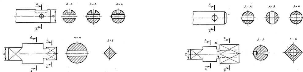
Поверхности вынесенных и наложенных сечений выделяют соответствующей штриховкой сплошными тонкими линиями. Положение секущей плоскости на чертеже показывают разомкнутой линией с указанием направления взгляда. Около стрелок с внешней стороны ставят прописные буквы русского алфавита (например, А-А, Б-Б). В сечении изображают, только то, что попадает непосредственно в секущую плоскость.
