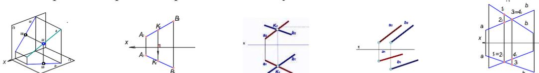
*Взаимное положение прямой и точки.* Если точка принадлежит прямой, то проекции данной точки должны принадлежать одноименным проекциям этой прямой (аксиома принадлежности точки прямой).  $A_1B_1 \in K_1$   $A_2B_2 \in K_2$   $K_1K_2 \perp OX$
