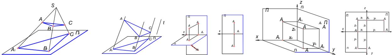
Где:  $S$  – центр проецирования;  $\Pi_1$  – плоскость проекций;  $A$  – объект проецирования;  $SA$  – проецирующий луч.  $SA \cap \Pi_1 = A_1$  – центральная проекция точки  $A$ . Центральное проецирование является наиболее общим случаем проецирования геометрических объектов на плоскости
