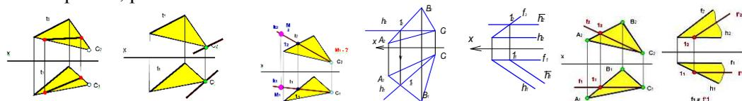
*Построение в плоскости горизонталей (фронталей).* При построении в плоскости горизонталей (фронталей) используем следующие свойства линии уровня плоскости: проекция любой горизонтали (фронталей) на плоскости  $\Pi_2$  ( $\Pi_1$ ) параллельна оси  $OX$ ; все горизонталей (фронталей) одной и той же плоскости параллельны между собой. Сказанное определяет следующий порядок построения проек-
