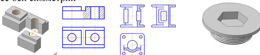
Не обозначают разрезы (горизонтальные, фронтальные, профильные), если секущая плоскость совпадает с плоскостью симметрии предмета в целом, а соответствующий разрез
