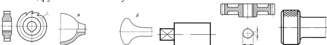
Пластины, а также элементы деталей (отверстия, фаски, пазы, углубления и т.п.) размером (или разницей в размерах) 2мм и менее изображают на чертеже с отступлением от масштаба, принятого для всего изображения, в сторону увеличения. Плоские поверхности на чертеже при необходимости выделяют диагональными сплошными тонкими линиями. Отверстия в ступицах колёс, шкивов и т.п., а также шпоночные пазы можно показывать лишь контуром отверстия или паза.
