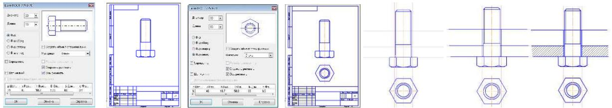
Для построения вида сверху еще раз вызываем диалоговое окно и выбираем Вид снизу (нам необходима проекция стержня болта). Формируем изображение. На панели Геометрия используем команды Вспомогательные прямые, Отрезок и Штриховка. Последовательно выполняем изображения деталей m и n, в которых выполнены отверстия диаметром 33мм (проводим вертикальные линии на расстоянии 1.5мм от стержня болта слева и справа). Толщина нижней детали – 20мм, толщина верхней – 30мм, ширина их не имеет значения.
