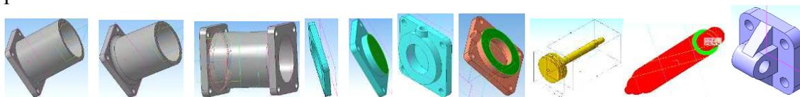
Вырезаем выдавливанием (панель *Редактирование модели*). В списке *Тип построения* необходимо выбрать *Через все*. Следует *Создать объект*. Выполняем скругления между фланцем и корпусом радиусом *5 мм*.
