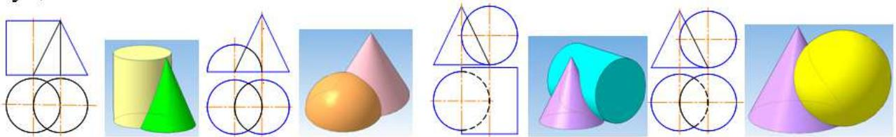
2. Построить проекции линии пересечения заданных поверхностей, используя способ секущих плоскостей.
