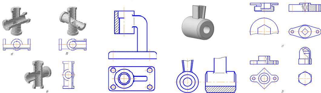
На половине вида не следует показывать линиями невидимого контура проекции внутренних очертаний детали, а на половине разреза не надо показывать линиями невидимого контура проекции наружных (с задней стороны детали) очертаний.
