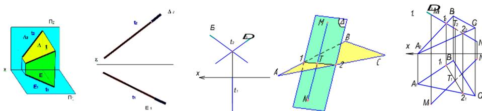
Для двух пересекающихся фронтально проецирующих плоскостей  $\Delta$  и  $E$  линией пересечения будет являться фронтально проецирующая прямая  $t$ . На фронтальной плоскости проекций она вырождается в точку  $t_2$ . Аналогично рассуждая можно определить линию пересечения проецирующих плоскостей с плоскостями частного и общего положения.
