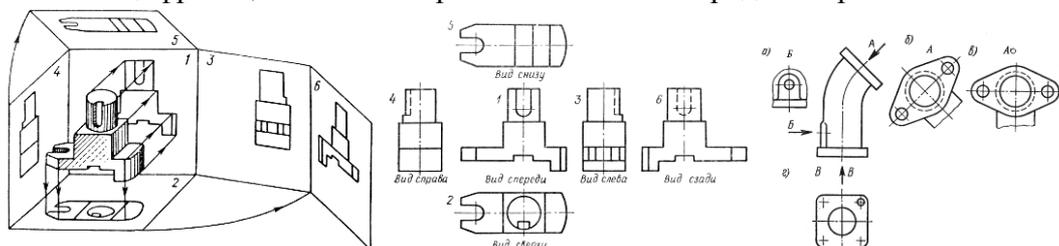
Изображение на фронтальной плоскости проекций принимается на чертеже в качестве главного. С целью уменьшения количества изображений допускается на видах показывать и
