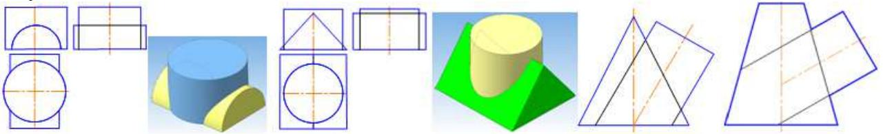
3. Построить проекции линии пересечения заданных многогранников. Построить развертки поверхностей. Построить аксонометрические проекции заданных многогранников.
