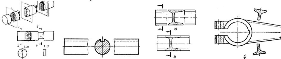
Наложенное сечение располагают внутри контура изображения детали и обводят сплошной тонкой линией, не прерывая контур изображения в месте расположения наложенного сечения.
