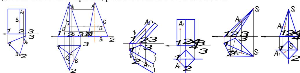
Для определения недостающей проекции точки, расположенной в одной из граней поверхности многогранника, необходимо провести через известную проекцию точки вспомогательную прямую.
