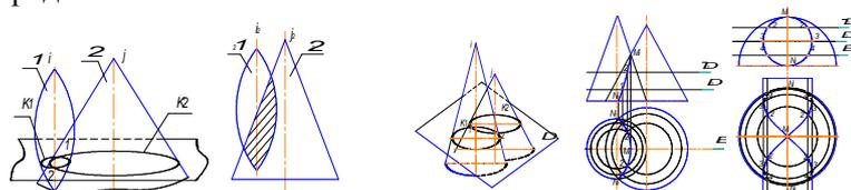
Наиболее общим методом нахождения линии пересечения двух поверхностей является метод посредников, при котором исходные поверхности пересекаются третьей (вспомогательной) поверхностью или плоскостью – посредником. Рассмотрим три случая взаимного пересечения исходных
