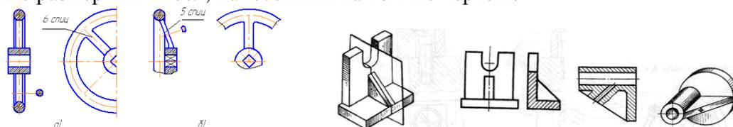
Условности и упрощения. Для облегчения чертежных работ ГОСТом предусматривается целый ряд упрощений и условностей. Болты, винты, заклепки, шпонки, непустотелые валы и шпиндели, шатуны, рукоятки и т.п. при продольном разрезе (если секущая плоскость проходит вдоль оси такого элемента) показывают не рассеченными, т.е. не штрихуют и проводят все линии видимого контура.
