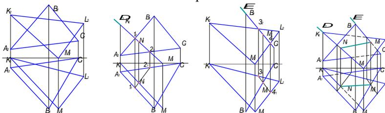
1 этап. Рассматриваем решение задачи на определение точки пересечения прямой  $KM$  из треугольника  $KLM$  с плоскостью треугольника  $ABC$ . 2 этап. Рассматриваем решение задачи на определение точки пересечения прямой  $BC$   $\Delta ABC$  с плоскостью  $\Delta KLM$ . Заканчиваем прямую  $BC$  во вспомогательную фронтально проецирующую плоскость  $E$ . Определяем линию пересечения вспомогательной плоскости  $E$  с треугольником  $KLM$  (3-4).
