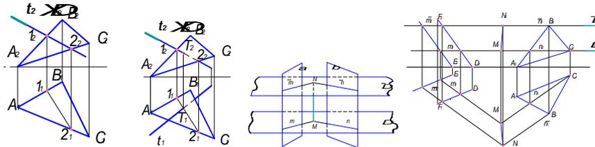
1 этап. Вводим плоскость-посредник  $\Delta$  параллельную плоскости проекций  $\Pi_1$  и проходящую через вершину  $C$  треугольника  $ABC$ . Определяем линии пересечения плоскости-посредника с исходными плоскостями  $\alpha$  и  $\beta$  -  $m$  и  $n$ . Их фронтальные проекции совпадают со следом-проекцией плоскости-посредника  $\Delta_2$ . По линии проекционной связи определяем горизонтальные проекции  $m$  и  $n$  -  $m_1$  и  $n_1$ .
