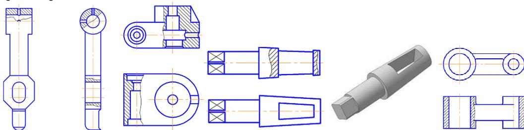
Стрелку вычерчивают только с одной стороны, но размер следует наносить полный; - допускается также разделять разрез и вид штрих - пунктирной линией, совпадающей со следом плоскости симметрии не всего предмета, а лишь его части, если эта часть представляет собой поверхность вращения. Если с осью симметрии совпадает линия видимого или невидимого контура, то видимость ее сохраняют, проводя волнистую линию левее или правее оси симметрии
