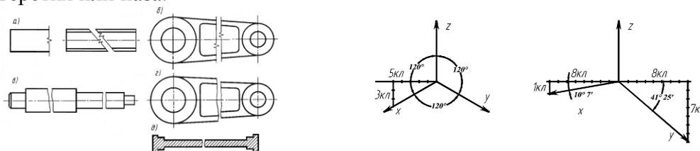
Также элементы предметов со сплошной сеткой, орнаментом, накаткой и т.п. можно изображать на чертежах частично с возможным упрощением. Длинномерные предметы или элементы, имеющие постоянное или закономерно изменяющееся поперечное сечение допускается изображать с разрывами.
