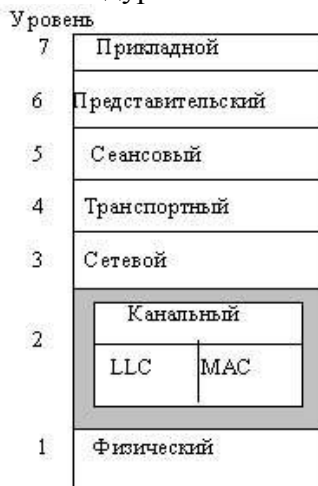
Рис.6.17. Эталонная модель для локальных компьютерных сетей
