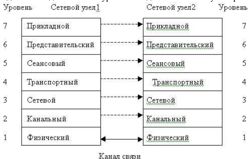
Рис. 6.18. Взаимодействие узлов сети на базе эталонной модели
