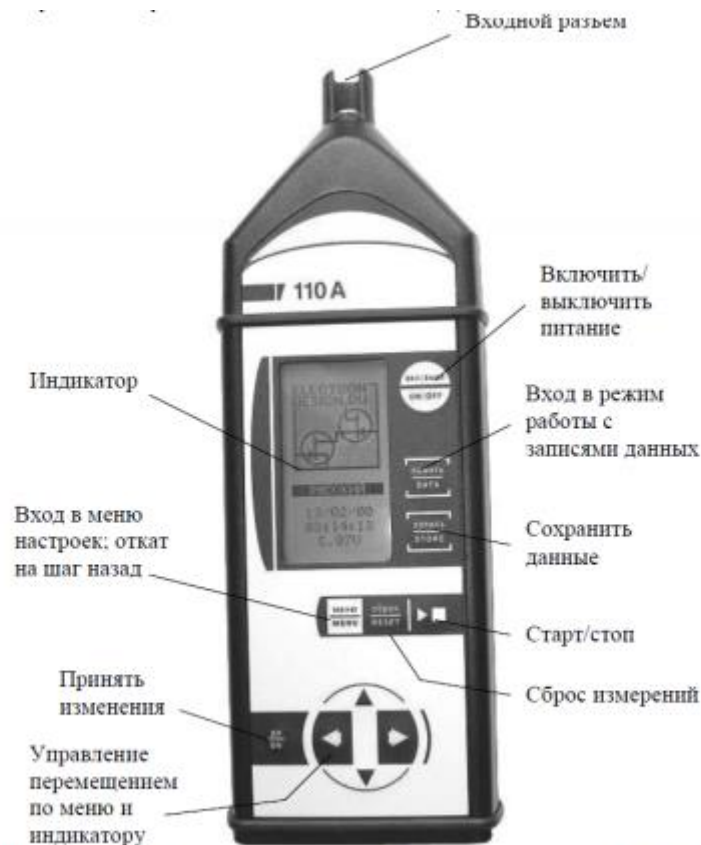
Рис. 4. Внешний вид и описание клавиш шумомера ОКТАВА-110А
