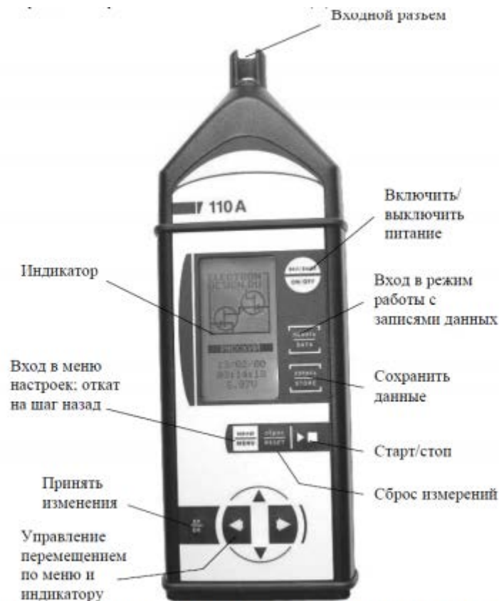
Рис. 4. Внешний вид и описание клавиш шумомера ОКТАВА-110А
