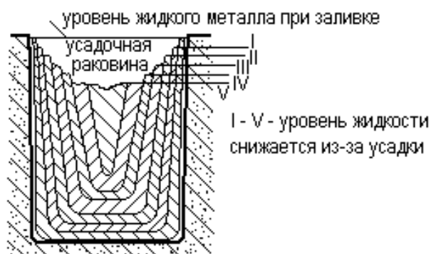
Рис. 2.2. Усадочная раковина
