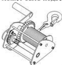
*Ручные лебедки* используют для работы с тяжелыми грузами. При вертикальном подъеме или опускании груза канат перебрасывают через подвесной блок. Используются ручные лебедки также для подтаскивания груза по специальным трапам.
