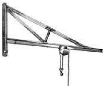
*Консольные ручные краны* используют для выполнения ПРР со штучными и тяжеловесными грузами, а также и контейнерами в пунктах с небольшим объемом работ.
