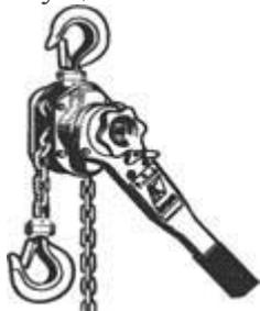
*Ручные тали* представляют собой простейшие подъемные устройства из нескольких подвижных и неподвижных блоков, огибаемых цепью. Редуцирующим звеном в таях являются обычно червячная или зубчатая передача, а также канатный или цепной полиспафт.
