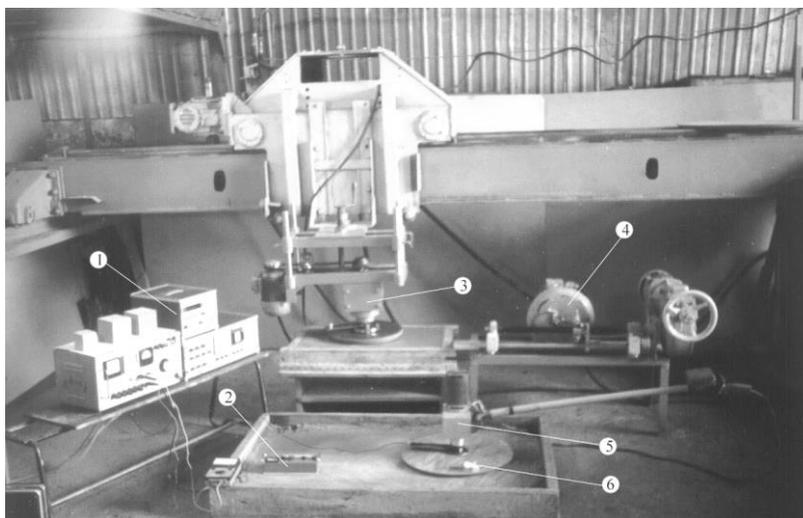
Рис. 1. Экспериментальный стенд вибрационной дисковой заглаживающей машины
