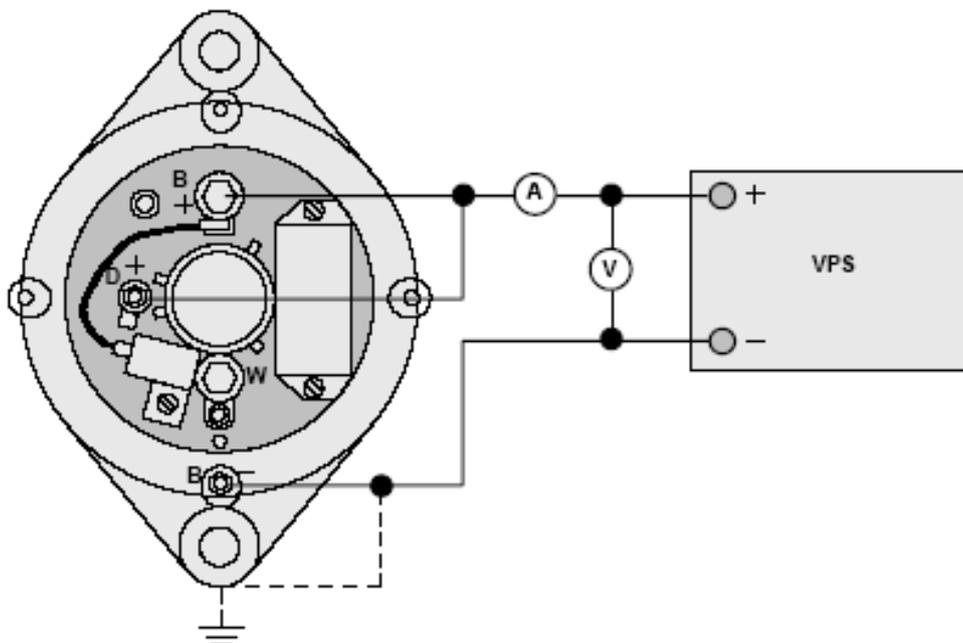
2. Отстройте напряжение источника регулируемого напряжения на величину, соответствующую появлению показаний тока на токовых клещах. Запишите напряжение включения тока \_\_\_\_\_ В.
